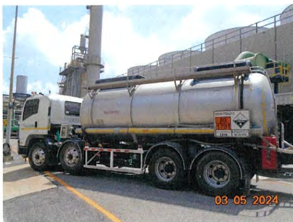
ภาพที่ 2.2-38 รถขนส่งสารเคมีหรือของเสียอันตราย ที่มีการติดชื่อ และเบอร์โทรศัพท์
