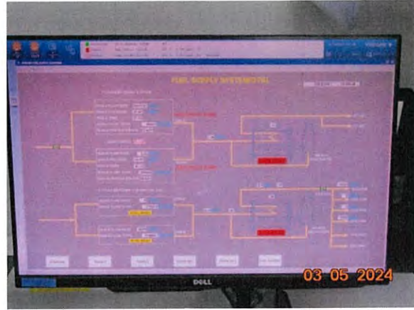
ภาพที่ 2.2-55 ระบบตัดระบบการลำเลียงก๊าซธรรมชาติจากห้องควบคุมส่วนกลาง
